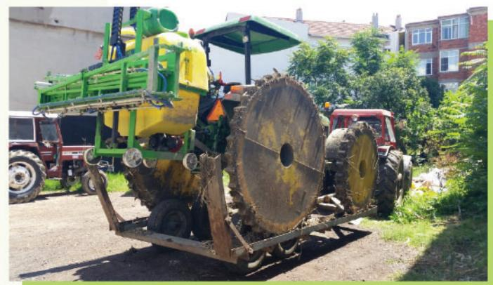
Фиг. 11 Пръскачка в Узункупрю, Турция (оставена с работен разтвор в резервоара)
